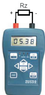
Obr.3 Zapojení ZUS32 v režimu generace napětí a proudu v aktivním režimu (SOURCE)
